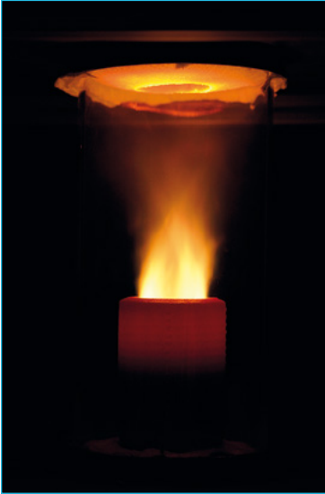
Abb. 3: Labordemonstrator mit Vorwärmzone im Betrieb mit 100 % \text{NH}_3 ( P_{\text{Brenner}} = 8 \text{ kW} , \lambda = 1,1 , S = 1,1 )
